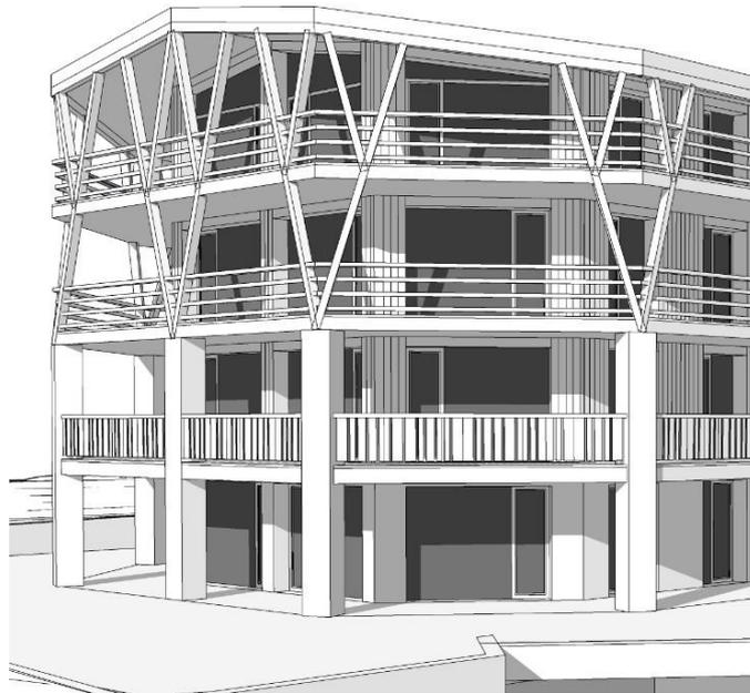
I parapetti sono di due tipologie, a doghe orizzontali in legno di Larice in tinta naturale per la parte alta, e a tavole verticali in legno di Larice a tinta scura, che garantiscono una maggiore privacy nella parte bassa e al piano lungo la strada. I balconi che corrono lungo gran parte dell'edificio creano delle linee orizzontali che abbassano percettivamente il volume.
